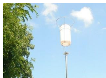
Figure 3. Préleveur d'eau de pluie (jauge Owen)
