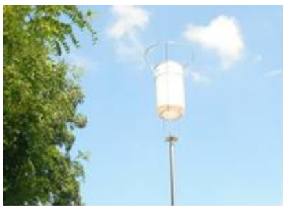
Figure 2 : jauges de récupération des eaux de pluie, dite « jauge Owen »
