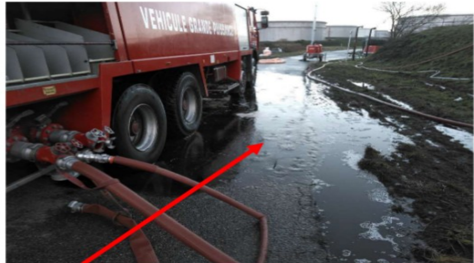
Fuite d'émulseur constatée au niveau du véhicule d'intervention grande puissance
